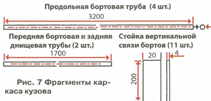
Рис. 7 Фрагменты каркаса кузова
